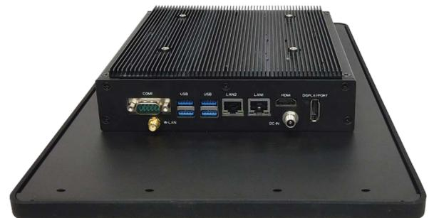
faytech's kapazitive PC-Serie hebt sich durch die lüfterlose Betriebsweise, das IP65 Front Design, einer hohen Zuverlässigkeit und der edlen Verarbeitung von der Konkurrenz ab.
