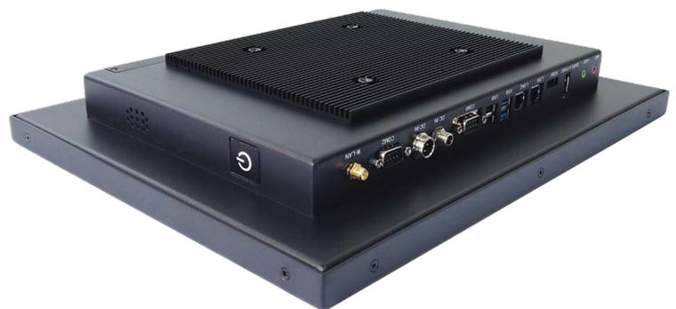
faytech's resistive PC-Serie hebt sich durch die lüfterlose Betriebsweise, einer hohen Zuverlässigkeit, Hochwertiges schwarzes Aluminiumgehäuse mit VESA 100 Bohrungen und der edlen Verarbeitung von der Konkurrenz ab.
