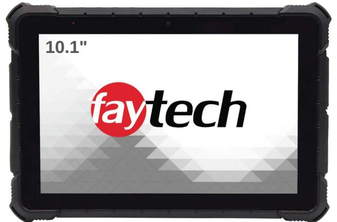
Das Industrie-Tablet (Ruggedized) von faytech ist die perfekte Touch-Lösung für den Einsatz als Handheld-Gerät (oder montierter PC) bei der Ausführung von Aufgaben auf dem Industrieboden oder in rauen Umgebungen. Es ist vollständig wasser- und staubdicht nach IP65, verfügt über ein kapazitives 10-Finger-Multi-Touch-Panel und eine antimikrobielle 24/7-Beschichtung von Kastus® mit einer Abtötungsrate von >99% gegen Oberflächenbakterien, herkömmliche Viren und humane Coronaviren (3-in-1 Schutz).
